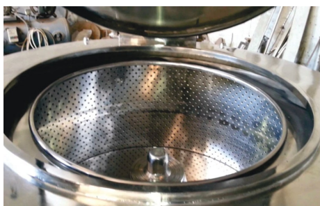
Essoreuse industrielle moderne : 'hydro-extracteur centrifuge'
